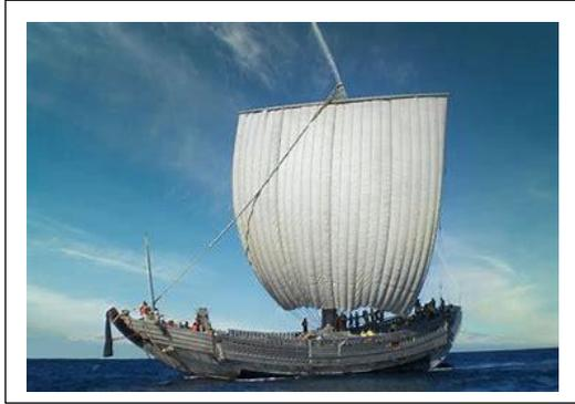
神昌丸：千石積の弁才船、船長約27m、高さ25m
