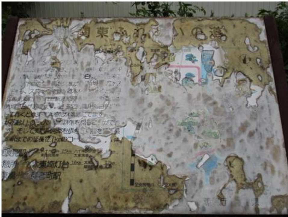
案内板の風化が激しくて、表面の保護版が剥げてしまった(首都圏自然歩道連絡協議会)
